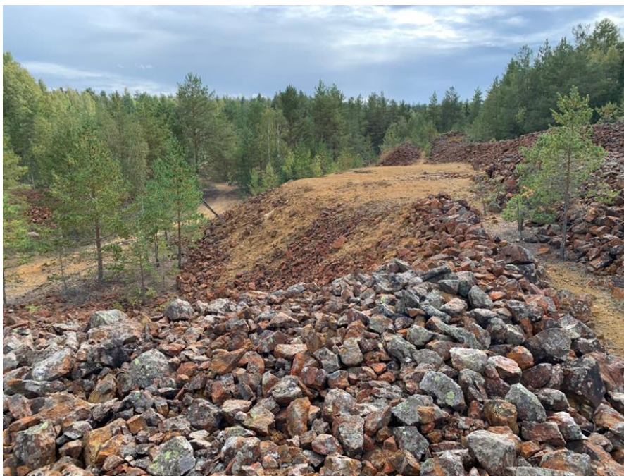
Figur 4. Karakteristiskt delvis rostvittrande varphögar (p.g.a. innehåll av sulfid-mineral), här vid Tomtebo gruvor, Dalarna. Foto: Helge Reginiussen.
